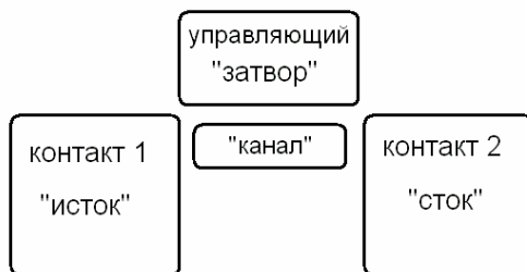
Рис. 1.1. Принципиальная схема транзисторной структуры с управляющим затвором
