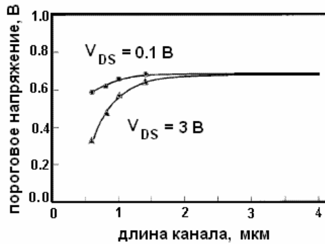
Рис. 5.7. Зависимость порогового напряжения от длины канала для транзисторов при разных напряжениях на стоке
